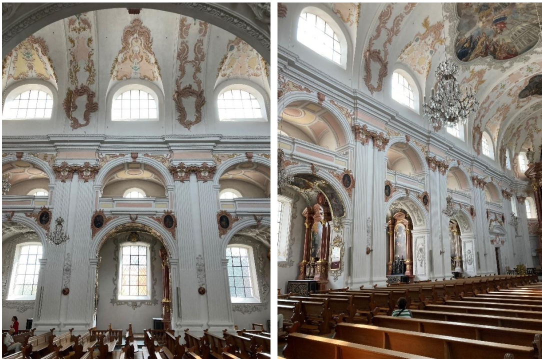
Lucerne, Jesuitenkirche, Innenraum nach Osten und Südosten. Der dreizonige Wandaufriß und der basilikale Querschnitt sorgen für unterschiedliche Lichteffekte in den Seitenkapellen, auf den Emporen und im Kirchenschiff.
