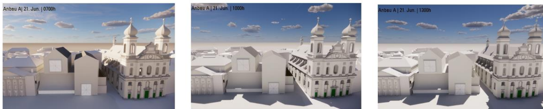
Tageslichtstudie Licht Kunst Licht AG: Simulation der Besonnung der Ostfassade der Jesuitenkirche bei einem Theater-Erweiterungsbau gemäss Wettbewerb. Dargestellt sind die Situationen am 21. Juni um 7.00 Uhr (links), um 10.00 Uhr (Mitte) und um 13.00 Uhr (rechts).
